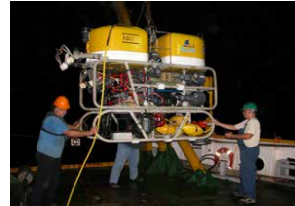
د. إنزال جهاز المستكشف الآلي في أثناء العمل في مياه جزر فرسان. d. Deployment of the ROV Max Rover during the Farasan cruise.
