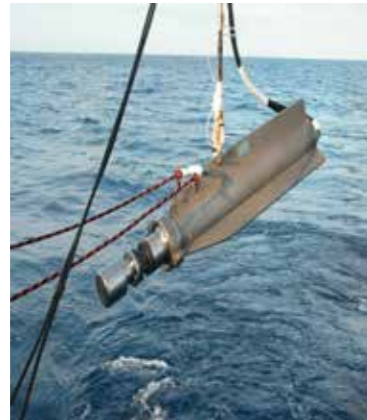
و. إنزال مدفع الهواء من السفينة. f. Deployment of Air Gun tow fish from the stern of R/V AEGAEO
