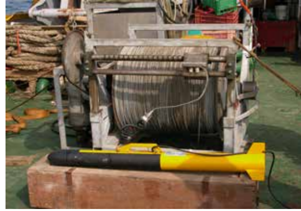
د. الأجهزة المستعملة على متن السفينة في أثناء مسح فرسان. d. Side scan sonar tow-fish and tow-cable winch on the working deck of R/V AEGAEO during the Farasan cruise.
