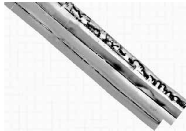
ب. صورة لرابية طولها ١١٢ رصدها جهاز المسح أحادي التردد بالناحية الشمالية الشرقية من الغور المنقاد في فرسان ٢ ويظهر الجرف ومنحدرات متباينة (باللون الرمادي والأسود) ترتفع من حد الرابية (باللون الأشهب) b. Side scan sonar mosaic of the -112m terrace along the northeastern flank of the elongate basin in the FARASAN 2 survey area. Note the strongly reflecting steep, irregular slopes (dark gray to black colour) rising from the edge of the terrace (light gray colour).
