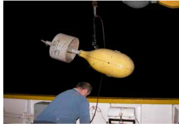
ب. إنزال ماسح القيعان تردده 3.5kHz على الجانب الأيسر للسفينة في أثناء المسح.
